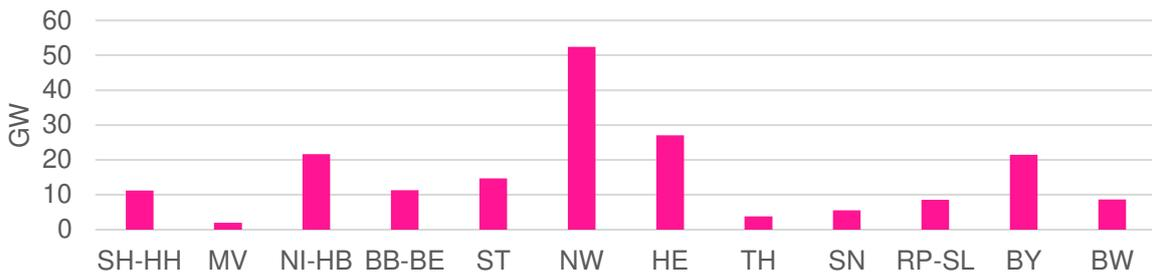
Abbildung 5.14: Installierte Kapazität der Elektrolyseure nach Knoten im RS in GW
