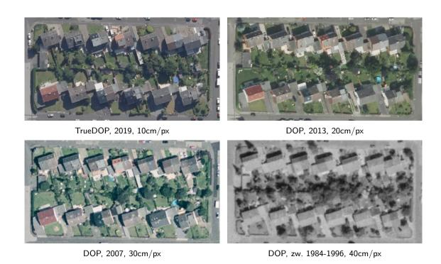
**Abbildung B.2:** Gegenüberstellug von TrueDOP mit DOP, historischen Aufnahmen und verschiedenen Bodenauflösugen des NRW Web Map Services. Bei den normaöen DOP Bildern erscheinen einige Häuser gekippt, sodass die seitliche Fassade sichtbar ist. [WMS21a]
