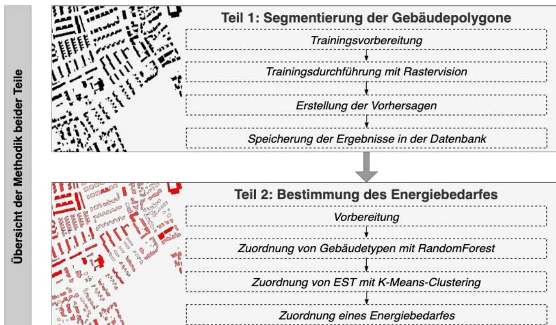
Abbildung 3.1: Überblick über die Hauptschritte des ersten und zweiten Teils der Methodik
